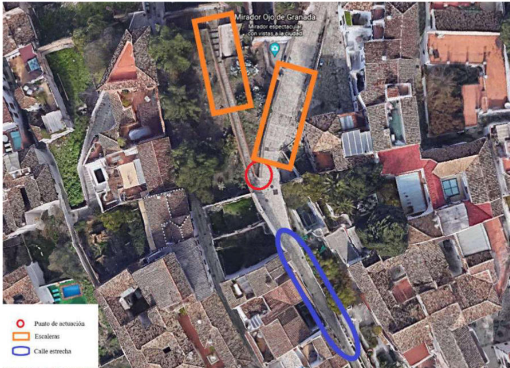
Figura 13.4. Representación de las zonas a considerar para acceder al punto de actuación, bien por las dimensiones de la calle (calles estrechas) o por las características de la misma (escaleras).
